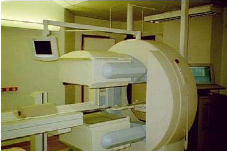
Bilden visar gammakamerasystemet Siemens ECAM med två detektorer.
